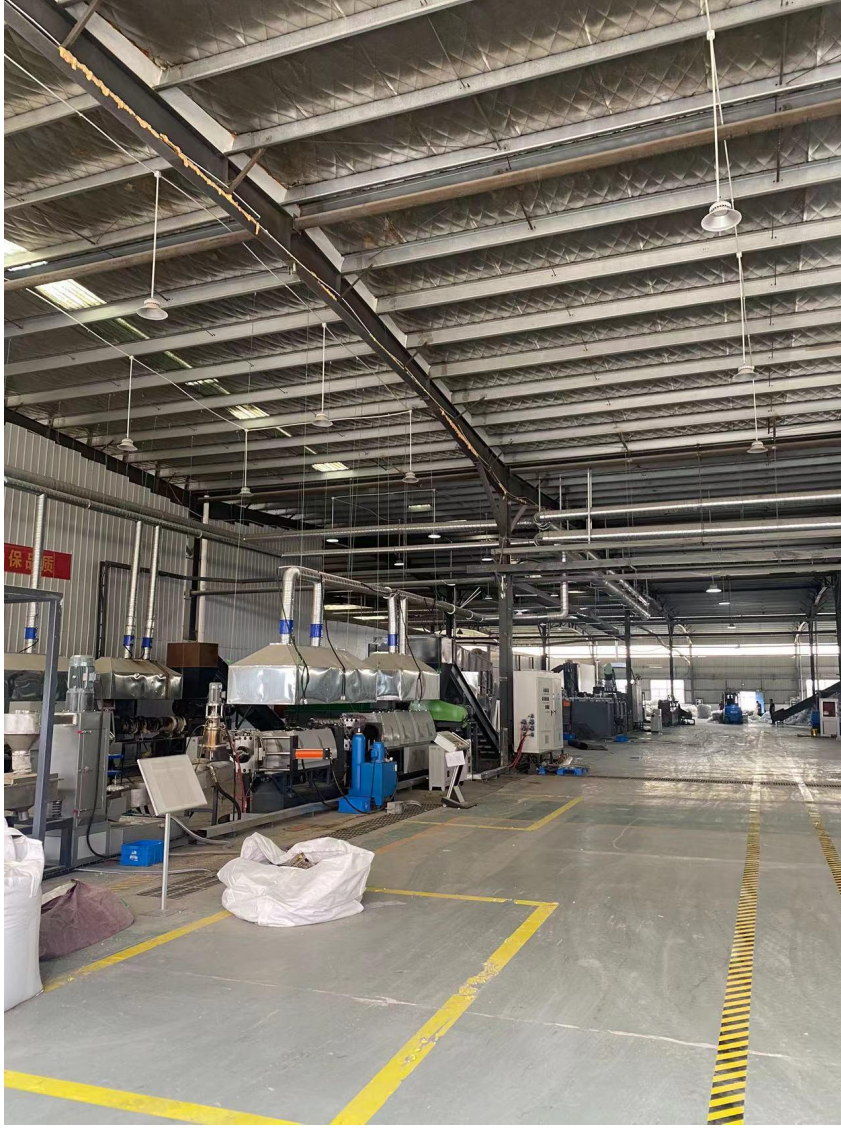
塑化废气经集气罩负压收集
